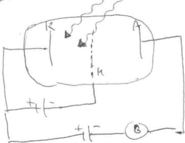
Při osvětlení osvětlení se emitují elektrony z katody, a měří se jejich energie (druhé je konečně elektrické pole)
